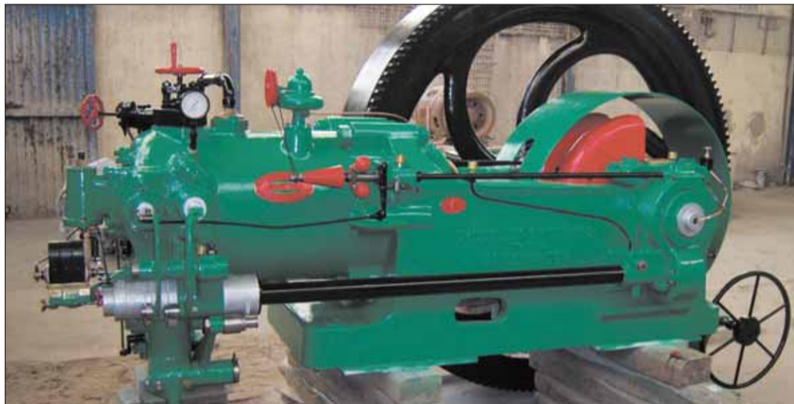
El motor anomenat 'De gas pobre' (Crosley&Brothers) de l'any 1909 provinent de l'antiga fàbrica de cartró de Can Magre, cedit per la família Matas-Parés i restaurat pel Club Ferroviario Vaporista de Mallorca.
